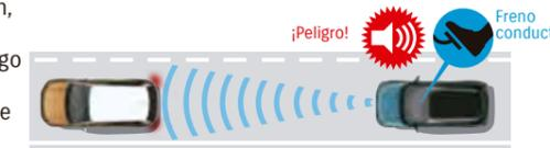
Condiciones de funcionamiento Para obstáculos fijos: funciona a velocidades entre 5 km/h y 80 Km/h, aproximadamente. Para obstáculos móviles: funciona a velocidades superiores a 5 km/h, aproximadamente.
