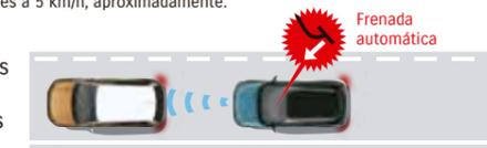
Condiciones de funcionamiento Para obstáculos fijos: funciona a velocidades entre 5 km/h y 30 Km/h, aproximadamente. Para obstáculos móviles: funciona a velocidades superiores a 5 km/h, aproximadamente.
